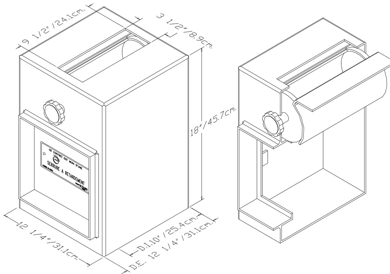
**Chute de dépôt de type 'Rotary Hopper'**
