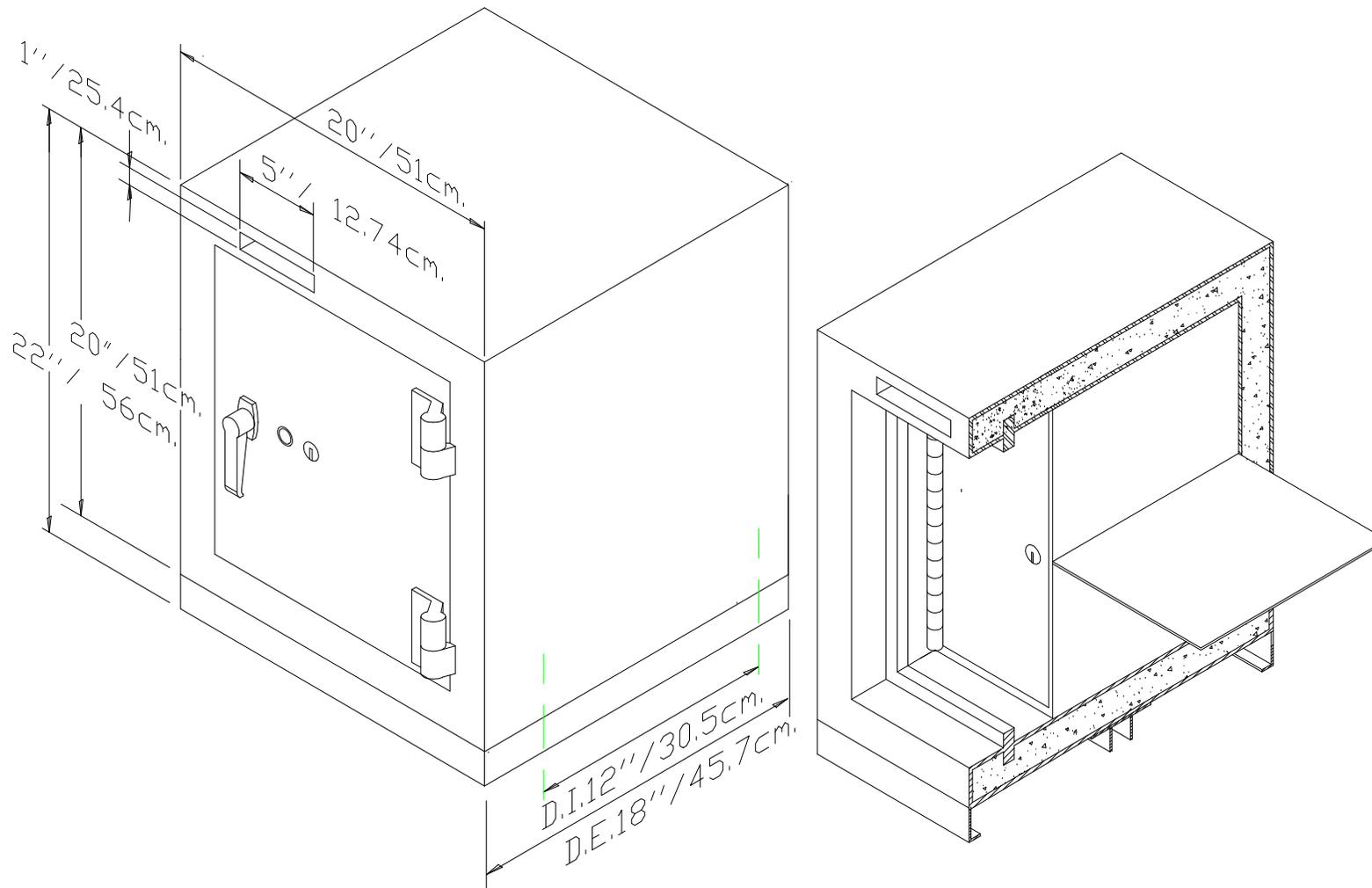
**Construction :** Alliage d'acier et de béton de type classe 2
